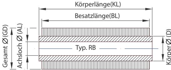
Typ Rundbürste mit eingesetztem Flansch
